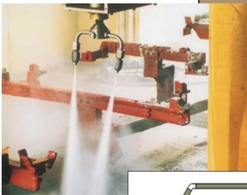
SPIN JET 自动清洗旋转喷射头，可节省人工
