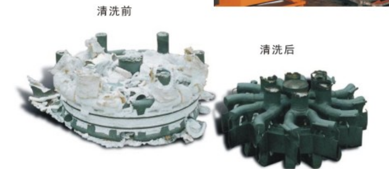
高压水射流清除加工螺纹上的毛刺
